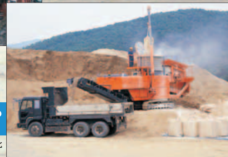
SR-P1800特殊仕様機：SR-P1200をベースに混合機容量を拡大させた仕様。処理能力は向上しますが、適応土質に限られます。
