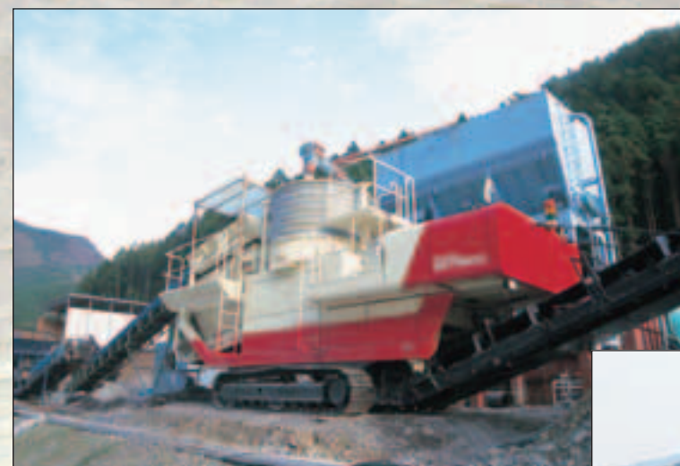
SR-P1800特殊仕様機：SR-P1200をベースに混合機容量を拡大させた仕様。処理能力は向上しますが、適応土質に限られます。
